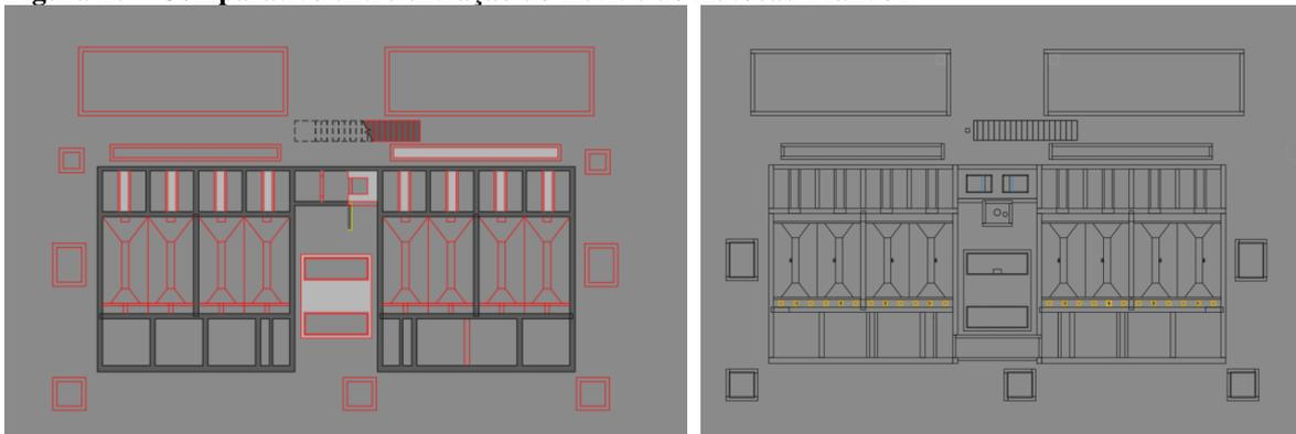
Dessa forma, é possível mesclar os benefícios da extração 2D do Revit, com melhor acabamento gráfico para as estruturas civis, com a extração 2D do Plant, e as vantagens de anotação automática das propriedades dos elementos de projeto hidromecânico.
