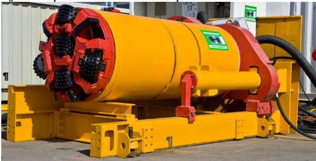
Figura 3 – Máquina AVN 800 HR e cravador compacto
