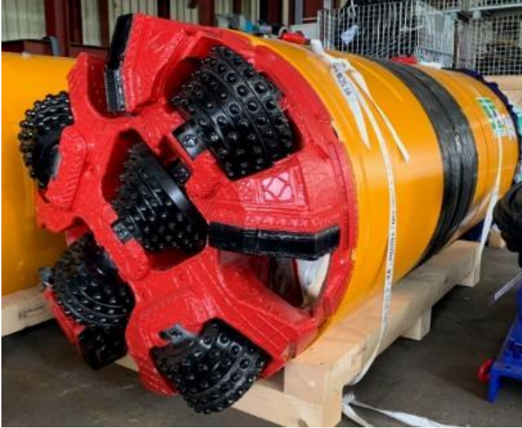
Figura 5 – AVN 800 HR projetada para operação em rocha dura
