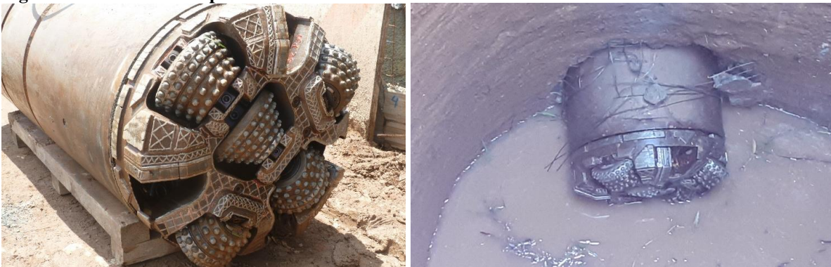
Figura 8 – AVN 800 HR após conclusão de um dos trechos
