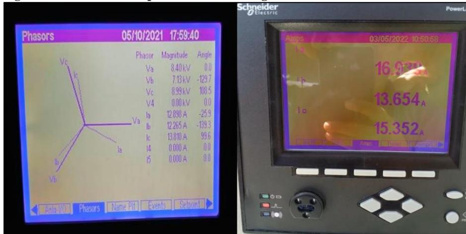
Após a configuração da comunicação e integração dos multimetro com sistema de monitoramento, é possível acompanhar distúrbios de tensão, harmônicas, corrente, fasores, entre outros. A figura 8 ilustra o funcionamento do sistema, com um distúrbio de milésimos de segundo entre as fases A,B e C.
