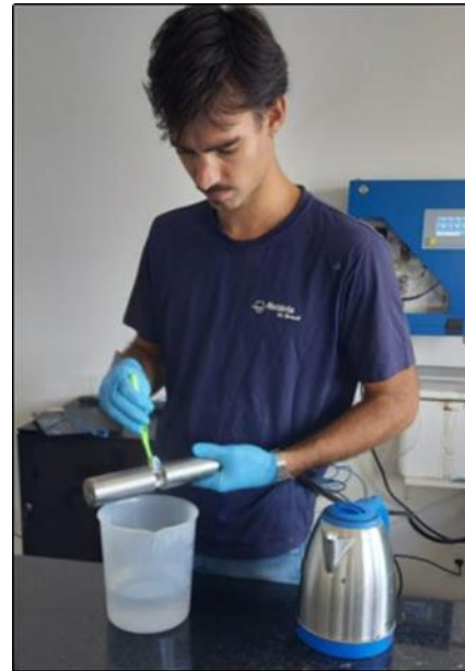
Figura 15 – Desligamento do sistema de limpeza automática de ar comprimido e limpeza da sonda UV/Vis na casa de operação – ETE do RS
