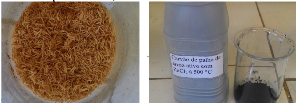
Figura 4 (A) Casca de arroz antes do processo de ativação (B) Carvão de casca de arroz ativo foto durante o processo de ativação com zncl_2
