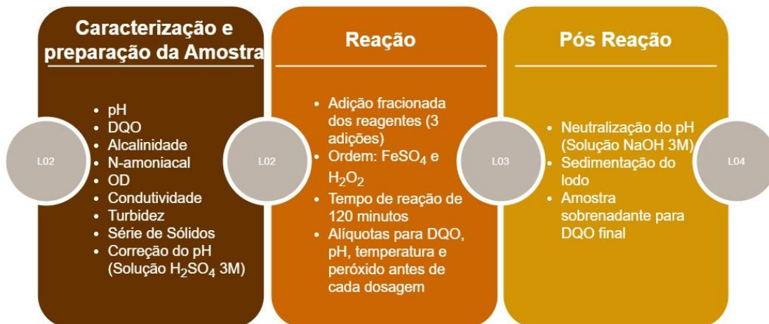
Figura 2 – Procedimento experimental: Fenton e Foto-Fenton Solar
