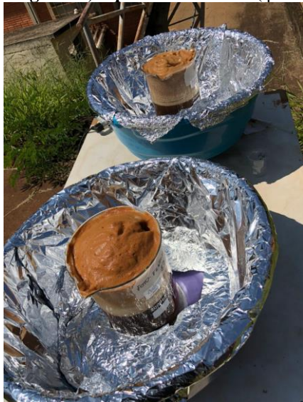
Figura 3 – Aparato experimental utilizado para o processo foto-Fenton solar, composto por agitador magnético, superfície refletora ( \phi = 40 cm; h=15 cm) e béquer de 2L
