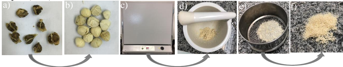
Figura 1 - Etapas de preparação do adsorvente: a) Semente de M. oleifera com casca; b) Semente de M. oleifera descascada; c) Estufa para secagem das sementes; d) trituração das sementes com almorafiz e pistilo; e) Padronização do tamanho de partícula na peneira de 28 mesh e f) Adsorvente da semente de M. oleifera (SMO).
