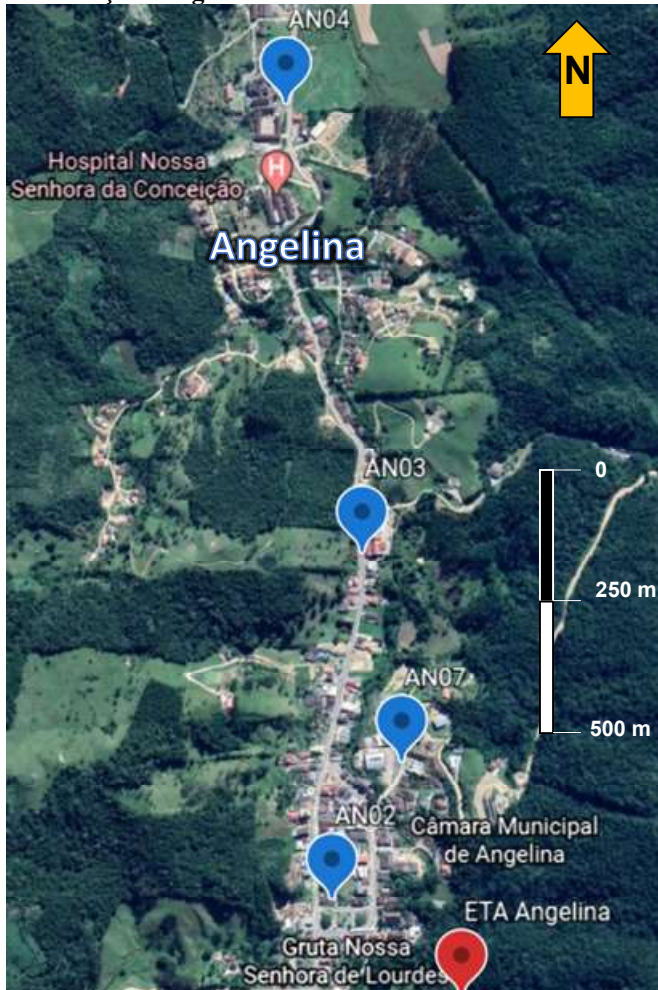
Figura 5- Localização geral dos 4 pontos de monitoramento de qualidade de água na rede de distribuição- Angelina/SC.
