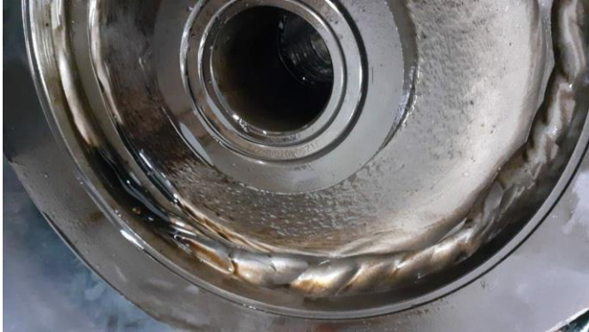
Figura 7 – Cavitação Gerada por Vórtices (Fonte: Arquivo Interno Engenharia e Cia)
