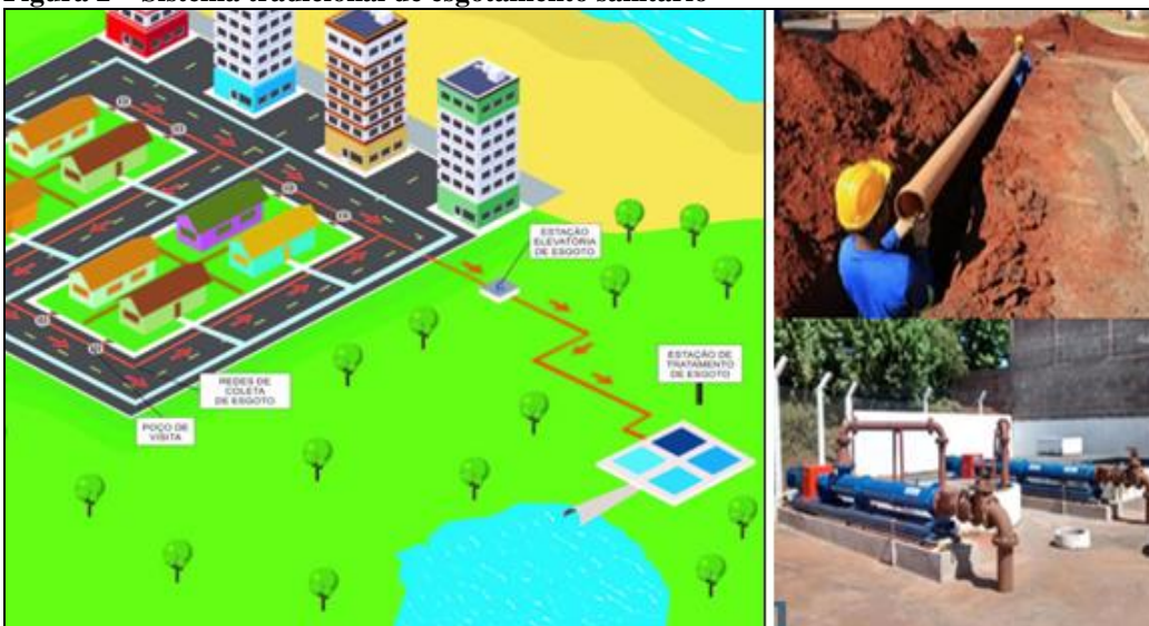
Figura 2 – Sistema tradicional de esgotamento sanitário
