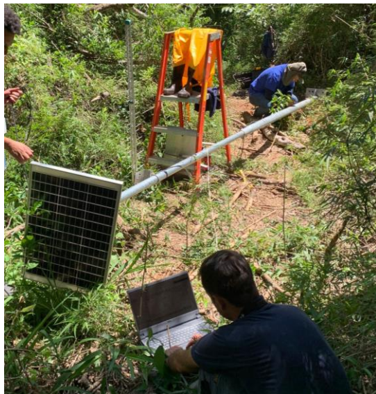
Figura 4c - Equipamento em manutenção, dispensando o trabalho em altura (NR-35) em localidade remota.
