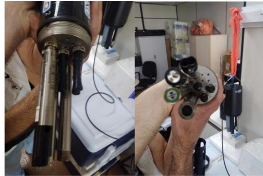
Figura 3.b - Sensores da sonda Multiparâmetros EXO (Xylem)
