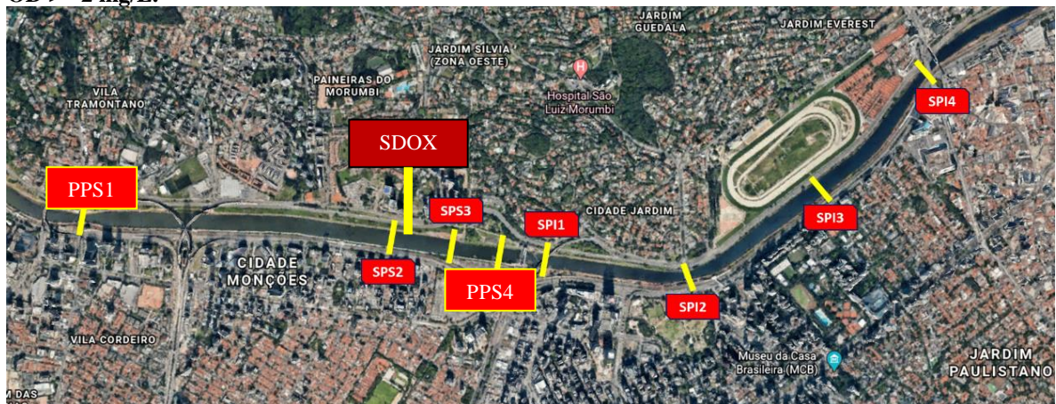
Figura 12 - Seções ao longo do trecho do Rio Pinheiros. No destaque, o ponto de montante PPS1 e o ponto PPS4 que são, respectivamente, o ponto a montante da dosagem do SDOX® e o ponto “meta” de OD \geq 2 mg/L.
