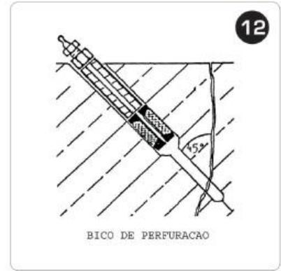
Figuras 13, 14 e 15 – Posicionamento dos bicos de adesão. Detalhe do bico de adesão e corte esquemático do posicionamento do bico em relação à trinca
