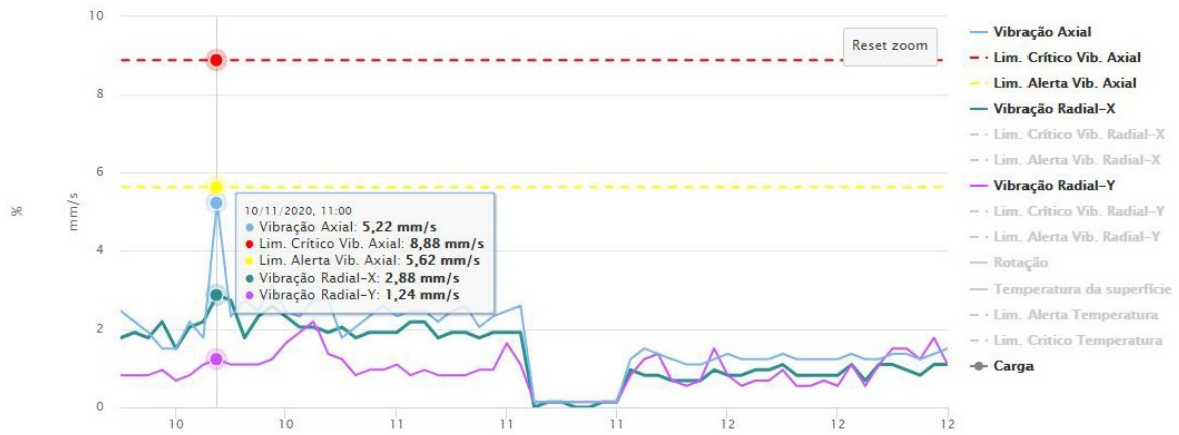
Figura 7 – Gráfico de vibração nos três eixos
