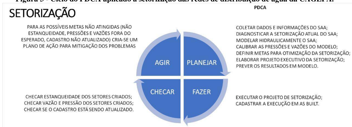
Figura 3 - Ciclo do PDCA aplicado à setorização das redes de distribuição de água da CAGEPA.
