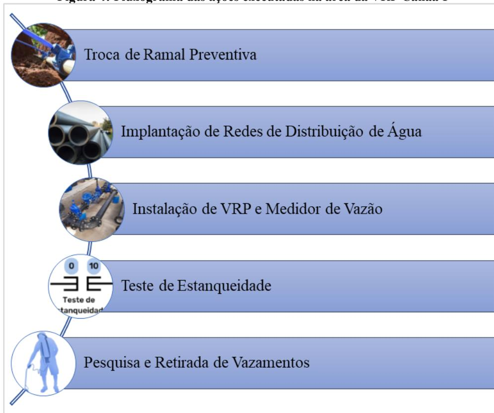
Diante da problemática encontrada, adotamos uma estratégia focada inicialmente na renovação de ativos, seguida pelo controle de pressão através de VRP. As varreduras de pesquisa e retirada de vazamentos possibilitaram um arremate final, concluindo a estratégia de redução de perdas para a área de estudo.
