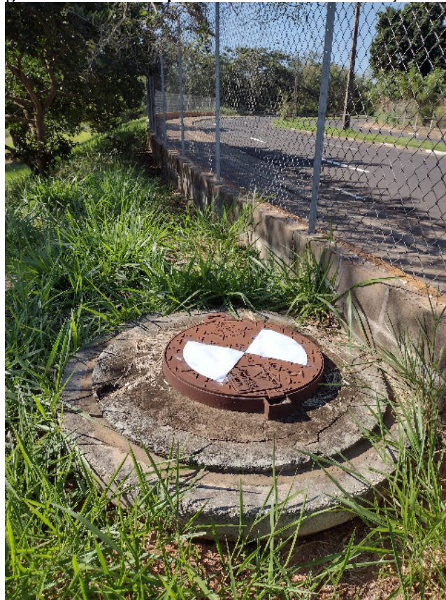
Figura 08 - Ponto de apoio do Drone com demarcação visual
