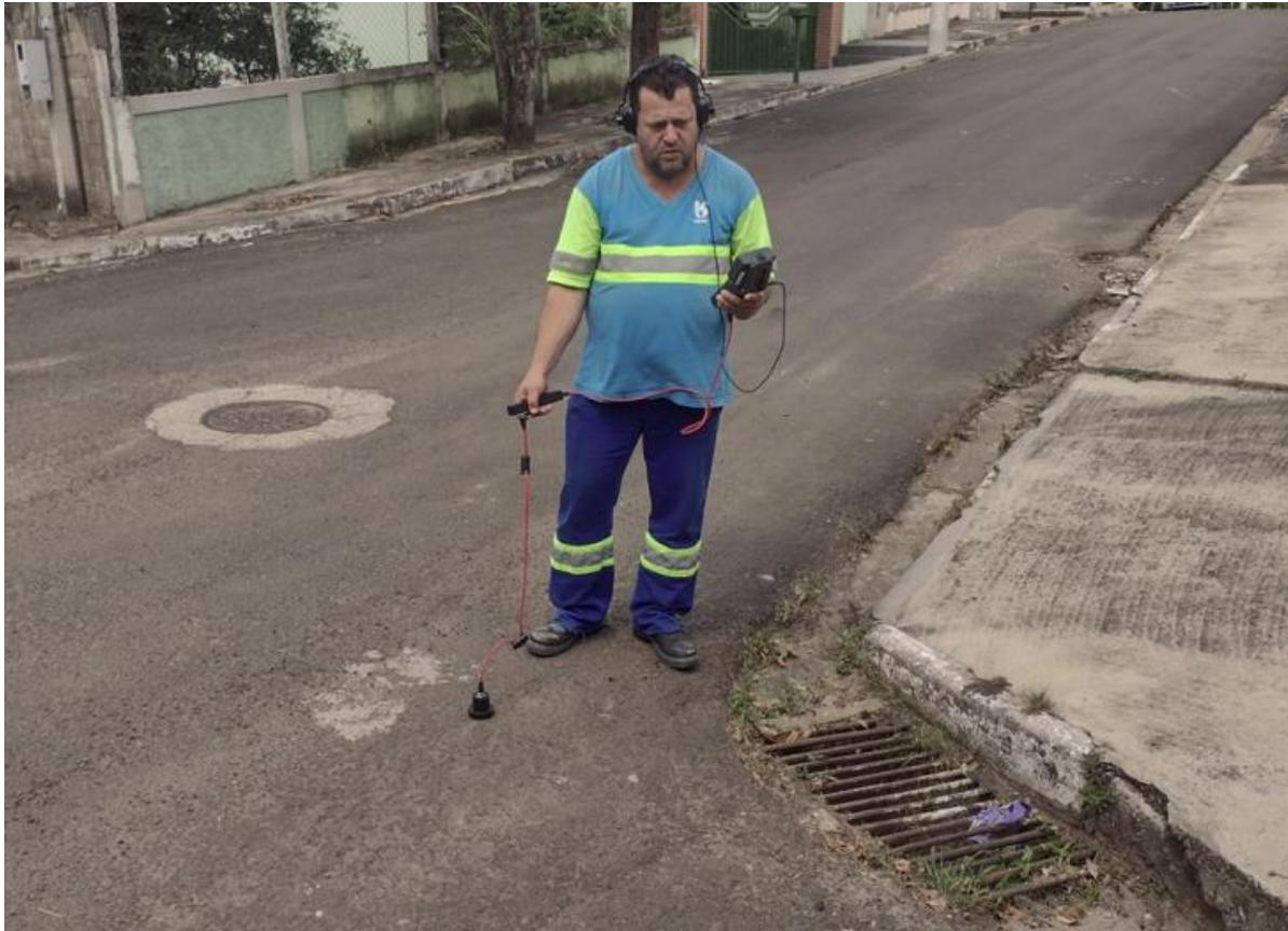
**Figura 2: Colaborador realizando pesquisa de vazamento de água utilizando o geofone**
